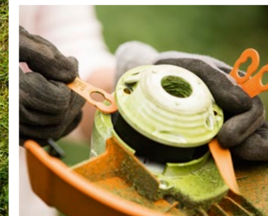
Les couteaux de rechange se remplacent aisément et rapidement.
